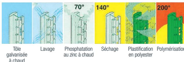
Tôle galvanisée à chaud    Lavage    Phosphatation au zinc à chaud    Séchage    Plastification en polyester    Polymérisation
