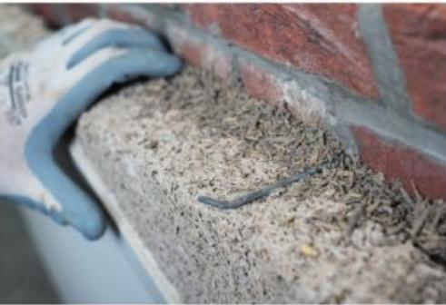
Grâce à sa grande perméabilité à la vapeur d'eau, le bloc de chanvre joue le rôle de tampon hydrique et offre un climat intérieur constant et sain pour les occupants du bâtiment. Le taux d'humidité relatif est ainsi stabilisé (de 50 % à 55 %).
